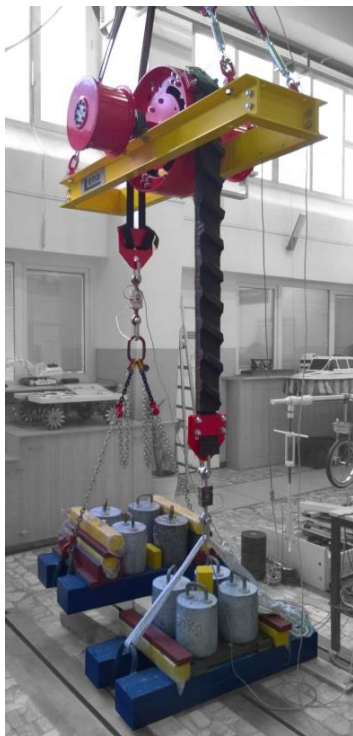
RYSUNEK 1. Stanowisko do identyfikacji oporów zginania zbrojonych taśm elastomerowych, opracowane w Katedrze Inżynierii Maszyn Roboczych i Pojazdów Przemysłowych Politechniki Wrocławskiej
